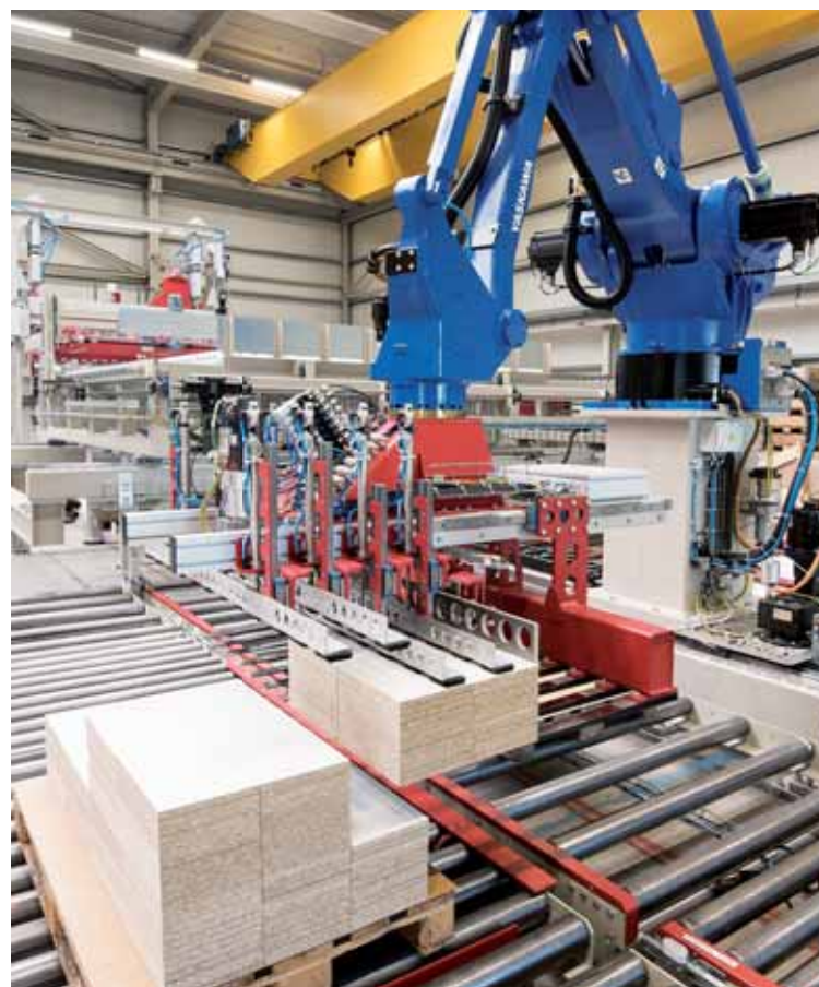
Neben einer Ausschleusstation für Halbformate gibt es eine vollautomatische Roboterabstapelung, die die Stapel für alle weiterführenden Anlagen bildet
