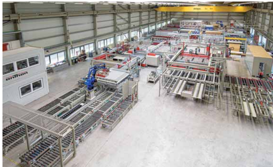
Die Gesamtanlage am FMD-Standort Melle nimmt eine Fläche von etwa 25 x 35 m ein. Links ist die Abstapelung mit Roboterzelle zu sehen
