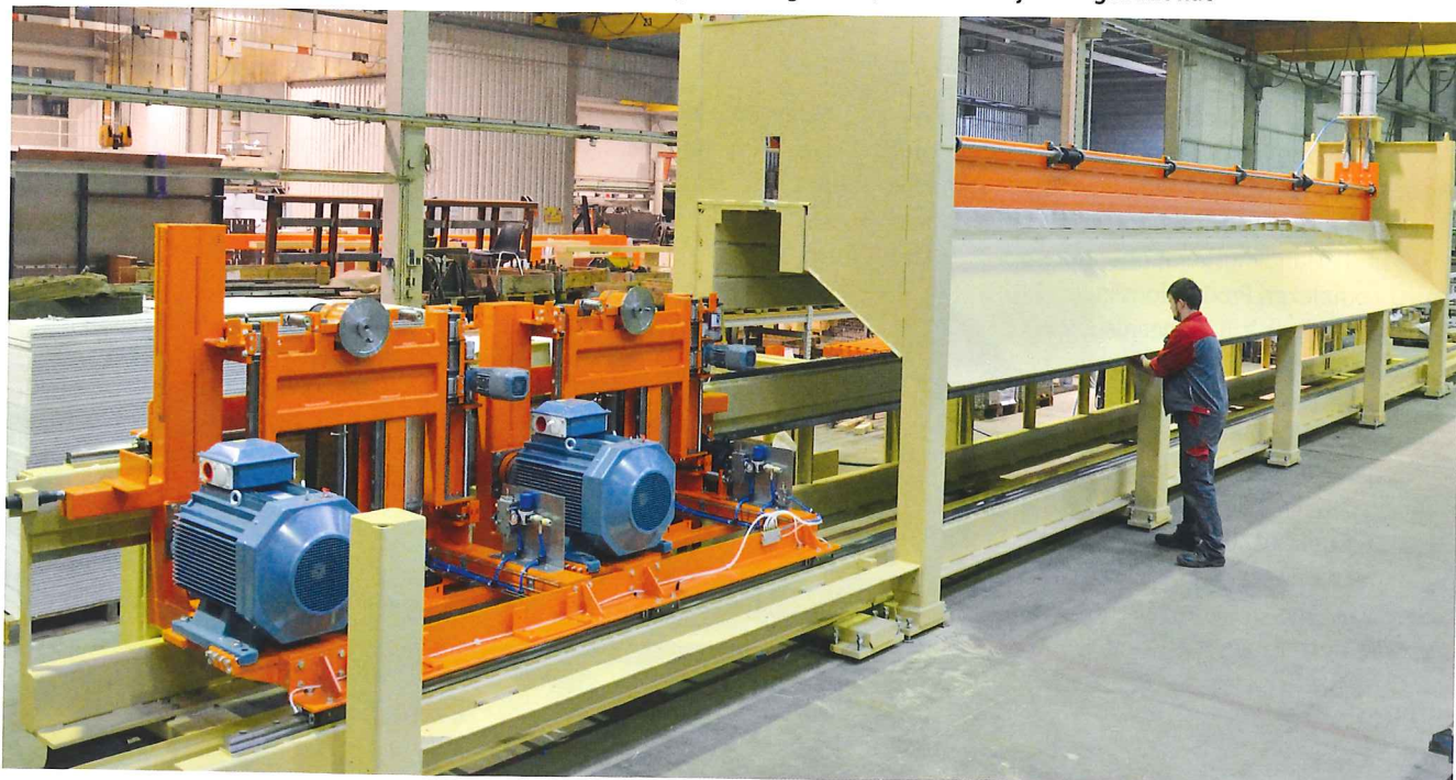
Mit einer Schnittlänge von 12 m gehört diese Druckbalkensäge zu den größten, die Anthon jemals gebaut hat
