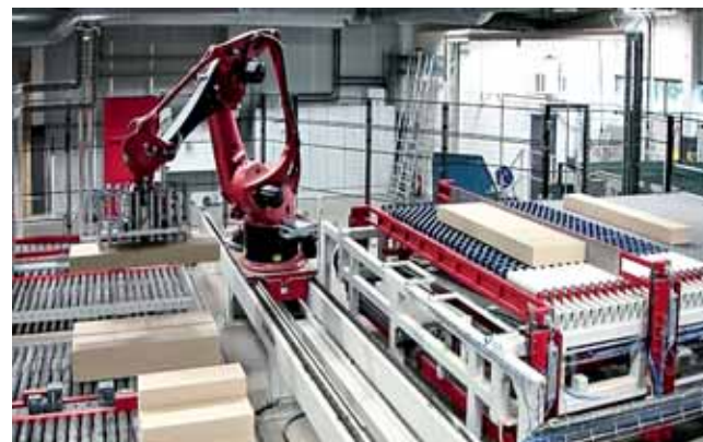
Bei der vollautomatischen Roboterabstapelung werden Schonplatten bzw. Paletten automatisch zugeführt. Die eigentliche Paketabstapelung erfolgt ebenfalls vollautomatisch durch die eingesetzten Roboter
