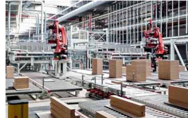
Bei der vollautomatischen Roboterabstapelung werden Schonplatten bzw. Paletten automatisch zugeführt. Die eigentliche Paketabstapelung erfolgt ebenfalls vollautomatisch durch die eingesetzten Roboter
